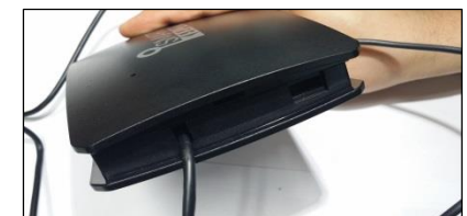
(1) Entferne mit dem Universalschlüssel das USB Port Lock an beiden Seiten des Link Lock HUB
